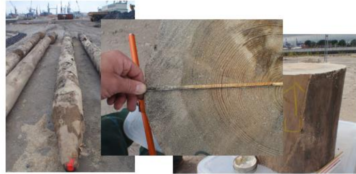
Grundlagenermittlung an vier gezogenen Langholzpfählen am Tollerort.
