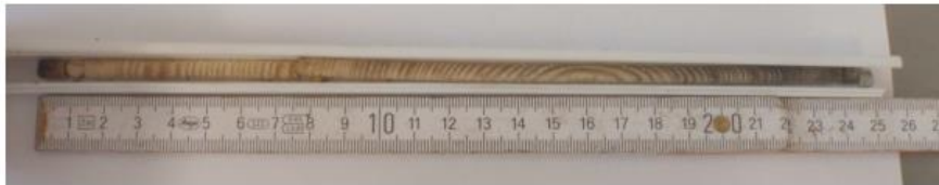
Bohrkernentnahme und Bohrwiderstandsmessung am Pfahl vom Speicher D
