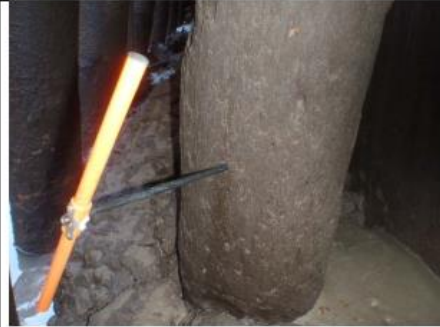
Bohrkernentnahme zur mikroskopischen Untersuchung an dem Pfahl mit einem Zuwachsbohrer
